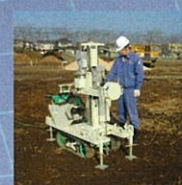
ラムサウンディング試験による地盤調査
